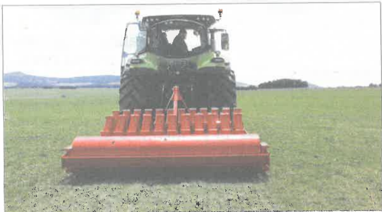
L'outil est équipé de 23 disques qui scarifient le sol sur une profondeur de 10 à 15 cm.
